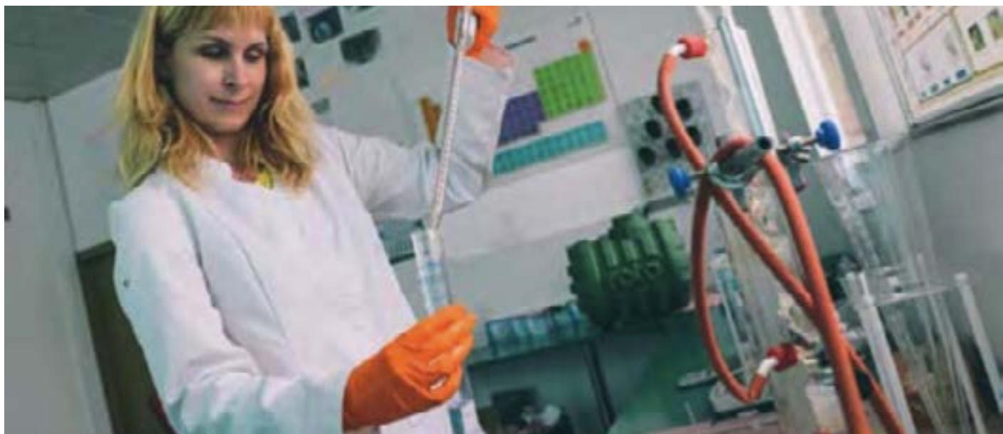
U ROTO laboratoriju analiziramo različite parametre otpadnih voda kao što su analize BPK<sub>s</sub>, COD, TOC, SS itd. Također obavlja unutarnje mikroskopske i mikrobiološke analize otpadnih voda, kao i učinkovitost rada separatora ulja.
