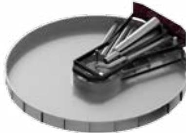
U konvencionalnim postrojenjima za pročišćavanje voda mora uvijek teći od dotoka do odljeva. U EkoFloat-R dio pročišćene vode vraća se u dotok koji je zasićen zrakom. Rotacija imitacije mosta je ravnomjerna, pa voda u spremniku teče po principu "NULA BRZINE" (bez kretanja) tijekom procesa flotacije. To omogućuje, unatoč učinkovito maloj površini i niskom kapacitetu pročišćavanje vode kroz proces flotacije.
