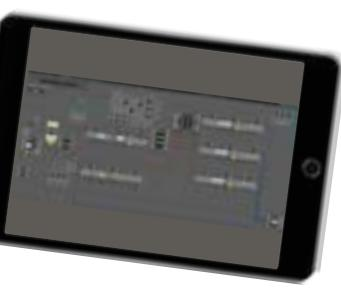
**SCADA upravljački sustav** je brz i transparentan način na koji korisnik pročistača može upravljati cijelokupnim procesom čišćenja, a ujedno mu omogućuje podešavanje rada prema ulaznim i izlaznim parametrima.
